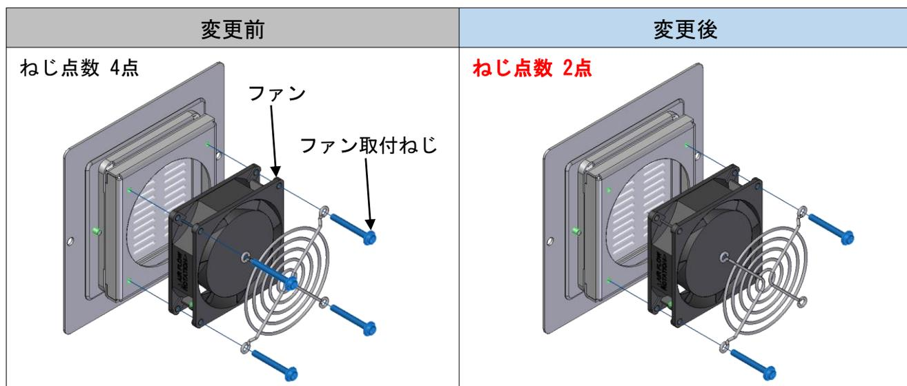
■ファン交換時、ファンを2点で取り付ける場合はファン取付ねじの取り付け位置はファンの対角線上になるように取り付けてください。
